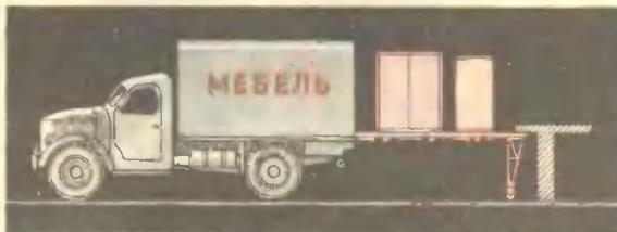
в фургоне. При разгрузке платформа опирается на кузов и складные стойки с колесиками. Если их убрать, платформа превратится в удобную тележку для транспортировки мебели со склада. Складные стойки позволяют вести погрузку и без грузовика. При этом надо ставить под платформу вторую опору или укреплять ее короткий конец под Т-образным упором. В этом случае с бочков платформы для прочности приделываются фермы-борта.
